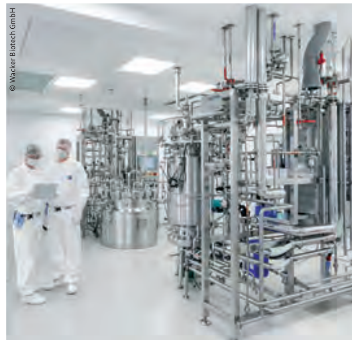
Biopharmazeutika werden in Stahlkesseln in einer sterilen Umgebung hergestellt.
