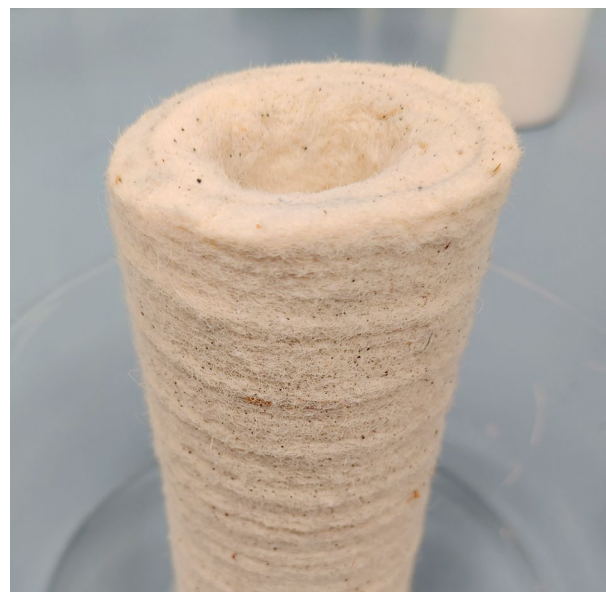
Im Projekt hergestelltes Filterelement aus Schafswolle
