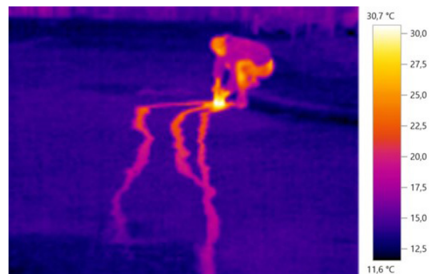
Die Wärmebildkamera zeigt thermal markierte Wasserfließwege auf versiegelten Oberflächen.
