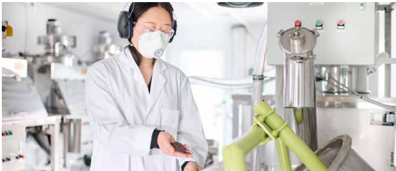
Abb. 1: Kontrolle der Korngröße der Düngergranulate in der Pontes Pabuli Versuchsanlage am Standort der Veolia Klärschlammverwertung Deutschland GmbH (VKD)
