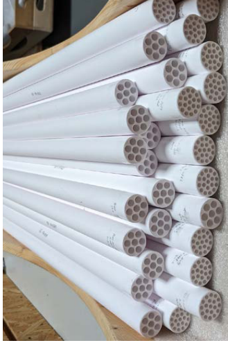
Keramische 7-Kanal- und 19-Kanal-Rohre für die Membrandestillation (Quelle: Fraunhofer IKTS)
