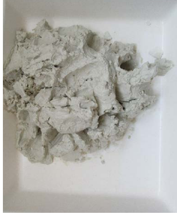
Hergestellter Gips aus der Pilotanlage (Quelle: G.E.O.S.)
