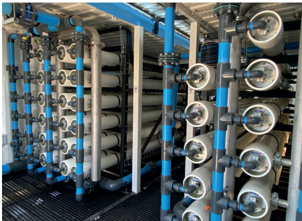
Module für die Nanofiltration: Die Membrantechnologie wird im Projekt MAMDIWAS für die Entsalzung von Grubenabwässern erprobt.
