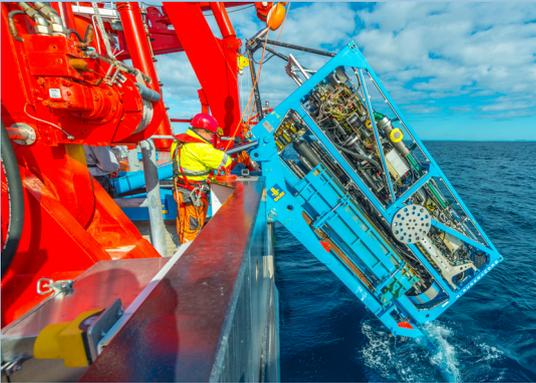
Das Meeresboden-Bohrgerät ersetzt häufig teure Bohrschiffe.
