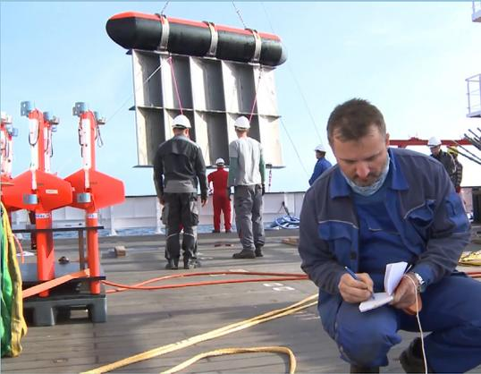
Scherbretter halten die 3D-Seismik in einer stabilen Konfiguration.
